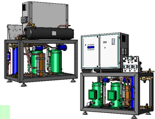
Schéma základního vybavení (systém nízkého tlaku oleje):
